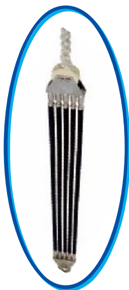
● Cima in poliestere ad alta tenacità e basso allungamento tipo Square Plated (colore bianco). ● Elementi elastici in elastomero rinforzato con tessuto intrecciato. Impiombato agli estremi in bussola d'acciaio inox AISI 316. (Da dimensionare in base alle specifiche di progetto). ● Corpo morto escluso. ● Accessori vari da valutare a parte.
